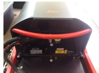
Leica ALS80 lidar sensor
